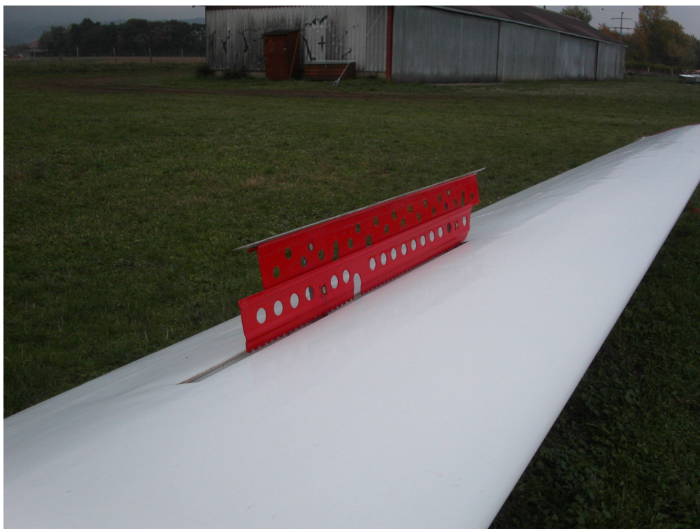
Fig. 13 : Aérofreins de type Schempp-Hirth (IS28).
