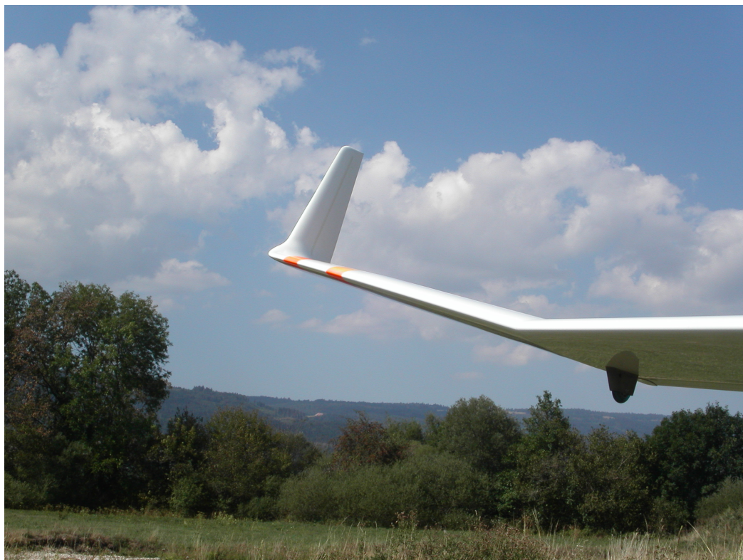
Fig.5 : Dièdre en bout d'aile et penna (Winglet) du DG-1000.
