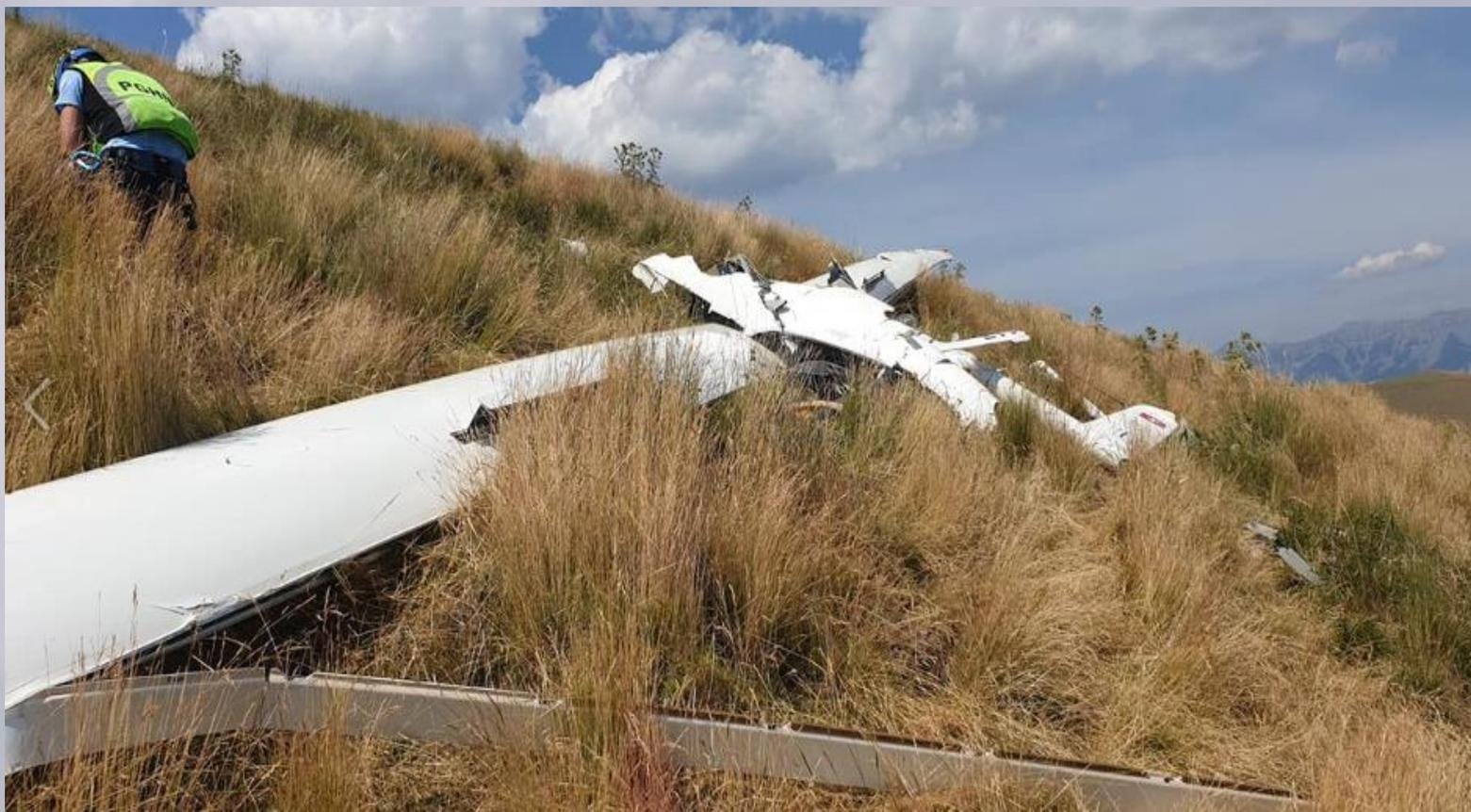
En septembre, un incident s'est produit avec une gouverne de profondeur partiellement bloquée sur un Duo Discus. En raison d'un corps étranger (noyau de ferrite), la gouverne de profondeur n'a pas pu être complètement braquée vers le haut. Ce blocage ne s'est pas manifesté lors de la commande normale et des manœuvres de vol modérées, seulement lors de cercles plus abrupts.
