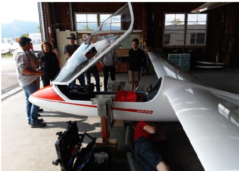
Fahrwerkskontrolle an der SZD
