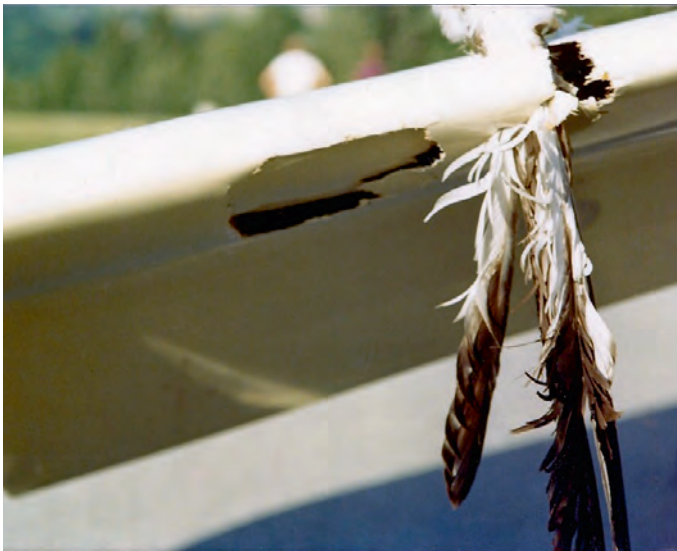
Abb. 1. Überreste eines Steinadlers und Schäden am Höhenleitwerk eines Segelflugszeugs nach einer Attacke des Adlers mit Kollisionsfolge im Juli 1975 am Sanetschpass (Kanton Bern). Aufnahme R. Notter. – Feather remains of a Golden Eagle and damages at the empennage of the glider after an attack of the eagle.
