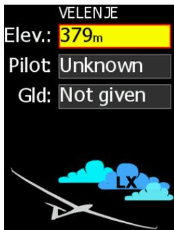
1. Schalte das Hauptgerät ein (ON). Die Initialisierung erfolgt (auch Flarm), der Bildschirm bleibt bei der Höhenwahl stehen.
